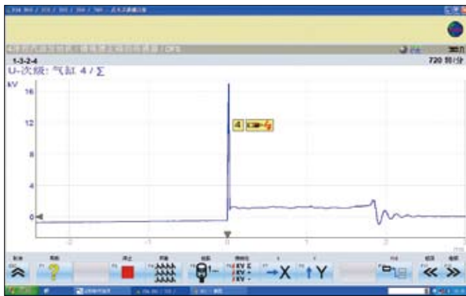
图17 点火过晚导致击穿电压过高的波形图
