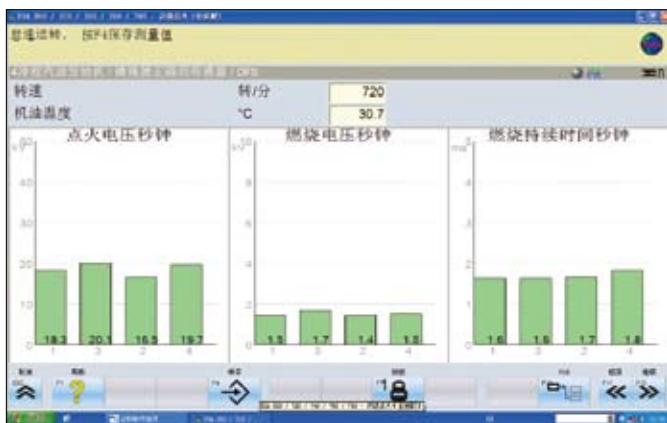
图18 点火过迟时的全适配波形图
