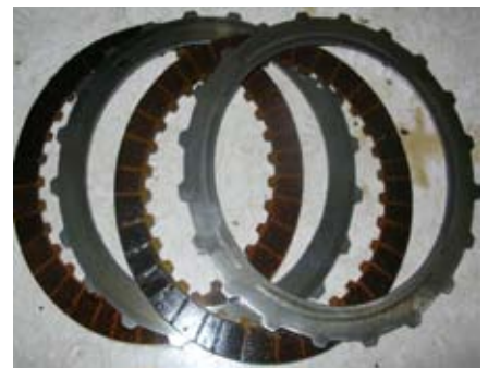
图3 轻微烧损的变扭器TCC锁止离合器片
