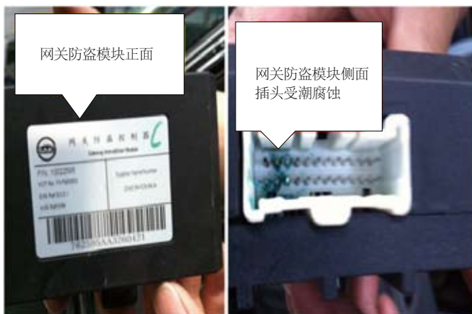
图3 网关防盗模块的正面和受潮侧面
