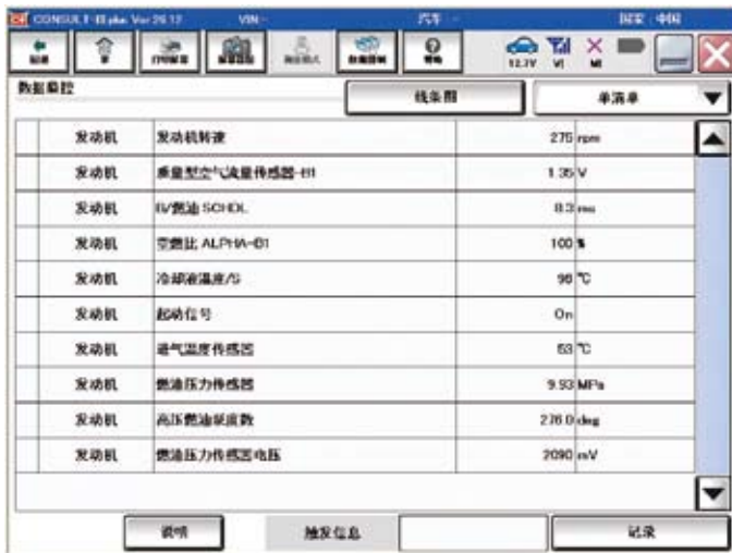
图2油压高导致车辆无法启动
