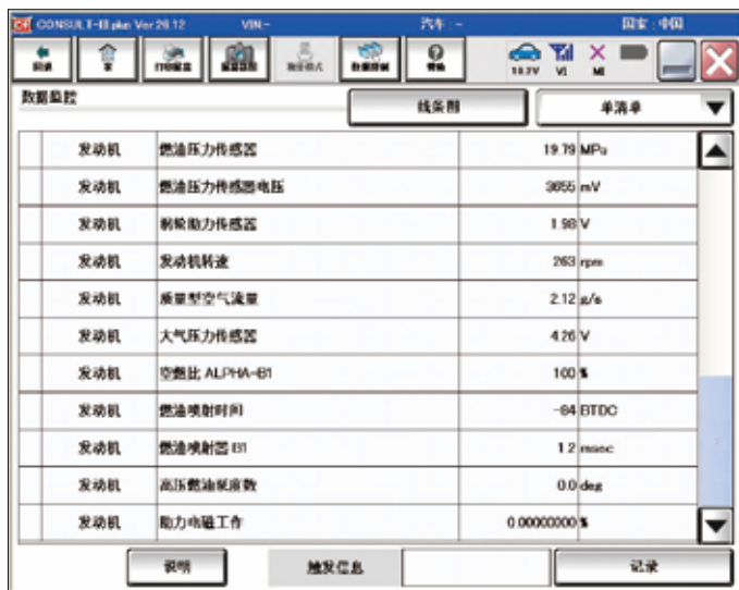
图3 油压达到极限时发动机熄火
