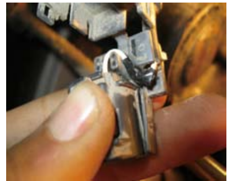
图3 用绝缘胶带重新包扎线束裸露部
