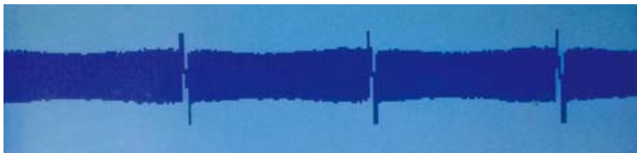
图1 正常的曲轴位置传感器波形图
