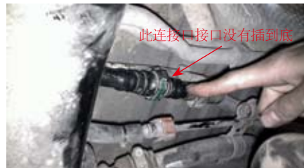
图2 接口A到油箱连接管路没有完全插到位
