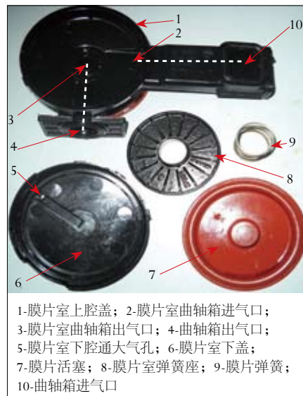
图2 膜片阀结构
