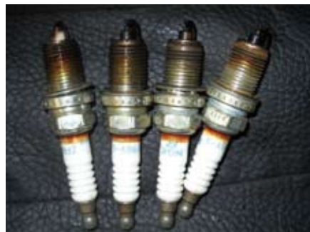
图4 火花塞的电极积液
