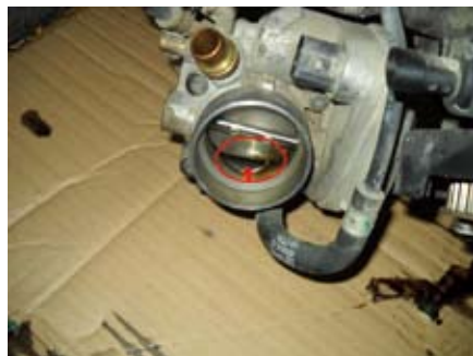
图5 节气门处的积液
