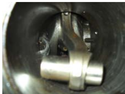
图6 发动机连杆顶弯
