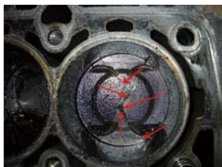
图7 发动机活塞顶裂
