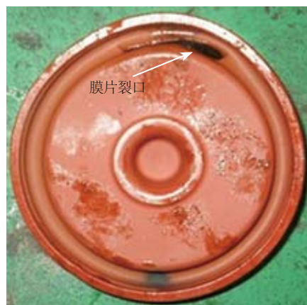
图8 气门室罩盖膜片阀膜片开裂
