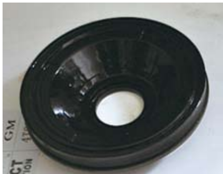
图2 通用5L40E变速器前进挡离合器活塞
