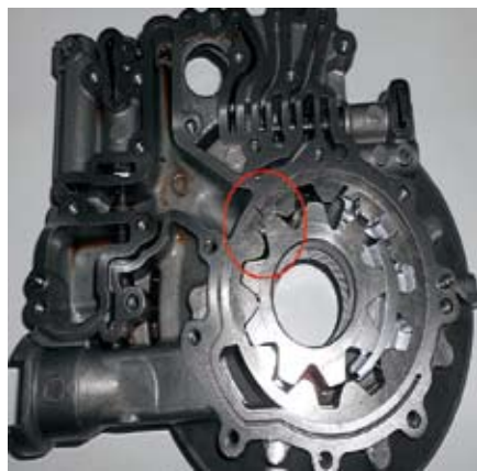
图6 损坏的6T45E油泵
