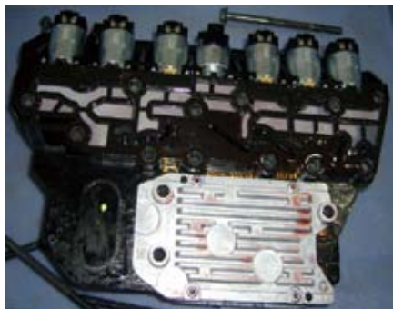
图3 通用6T40E变速器电脑(带电磁阀组)
