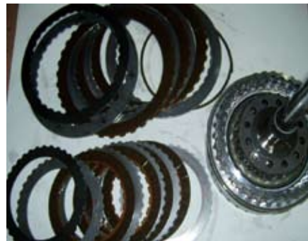
图4 通用6T40E变速器中3/5/R挡离合器
