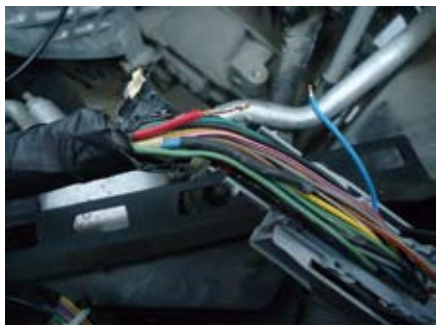
图5 节气门位置传感器信号导线断路
