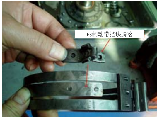
图1 F3制动带挡块脱落
