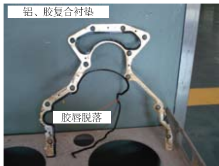
图8 衬垫胶唇脱落
