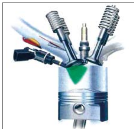
图13 FSI燃油分层喷射燃烧方法及其高压喷油器喷雾油束的形成
