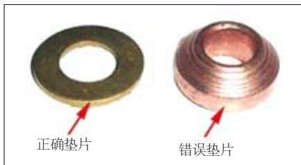
图1 喷油器下方的垫片
