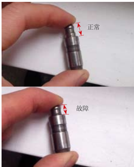
图2 排气门液压挺柱
