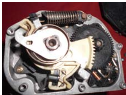
图10 对节气门体内部元件进行检查
