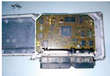
图7 拆下ECU检查
