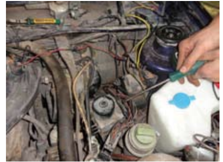
图3 ABS电脑的CAN-h断路位置
