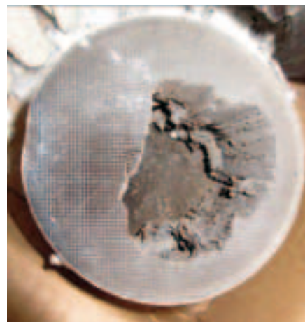
图3 “后燃”造成催化器内部碎裂
