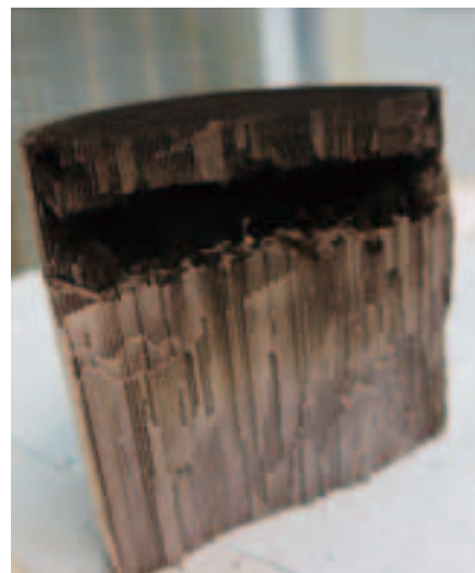
图4 表面完好但内部损坏的催化器
