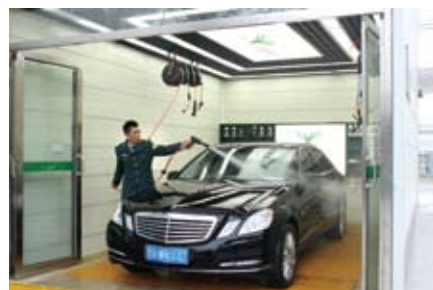
图5 气动微水高压清洗枪
