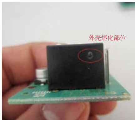
图9 轻微熔化的继电器外壳
