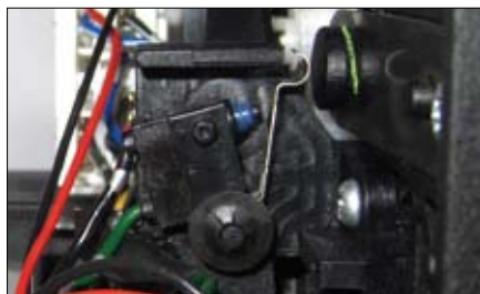
图2 微动开关脱落
