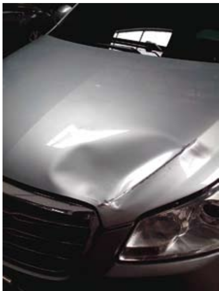
图3 利用制造时存在的加工硬化进行车身修复
