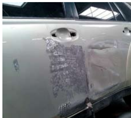
图9 退火工艺进行车身修复
