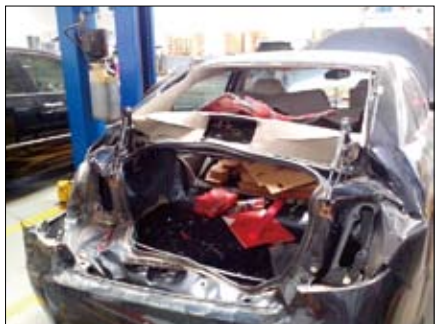
图1 车身碰撞造成的严重变形
