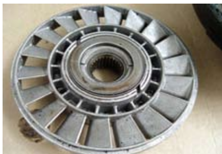
图2 导轮和单向离合器
