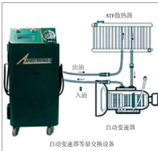
图16 利用换油设备进行变速器保养
