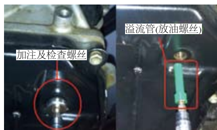
图20 大众途锐0C8 8挡变速器ATF加注、检查及排放位置
