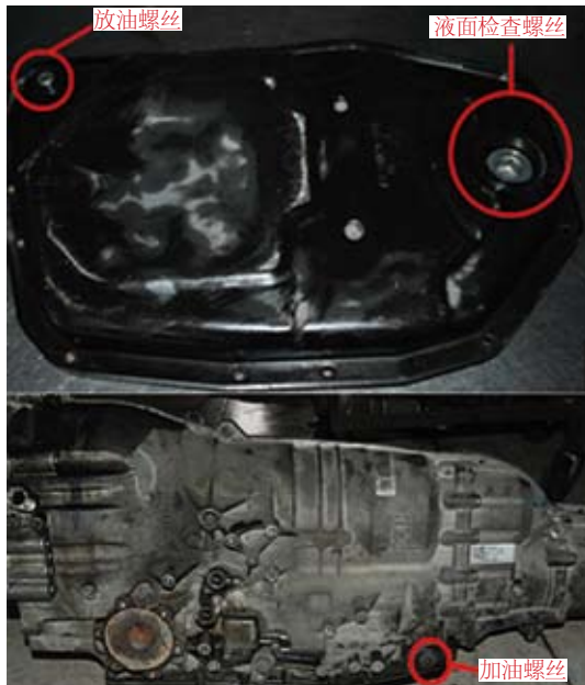
图17 奥迪09L变速器液位及加注位置
