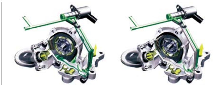
图24 具有两级压力控制功能的体积流量可调式机油泵
