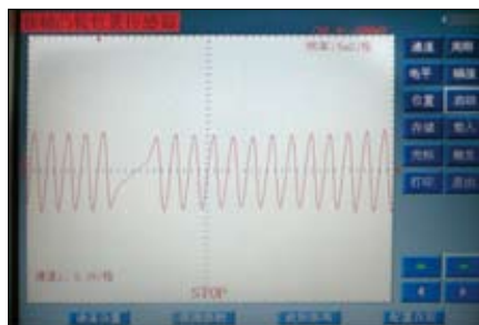
图2 启动机带动下的曲轴位置传感器波形
