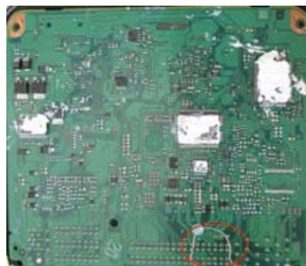
图5 发动机电脑的修复方案
