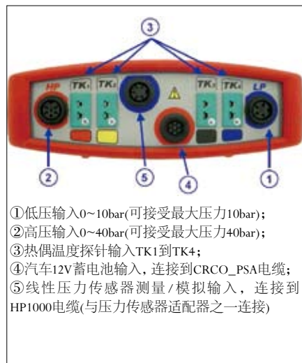
图3 诊断仪连接
