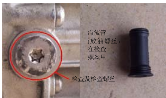
图23 奥迪最新0AW变速器加注、检查及放油位置
