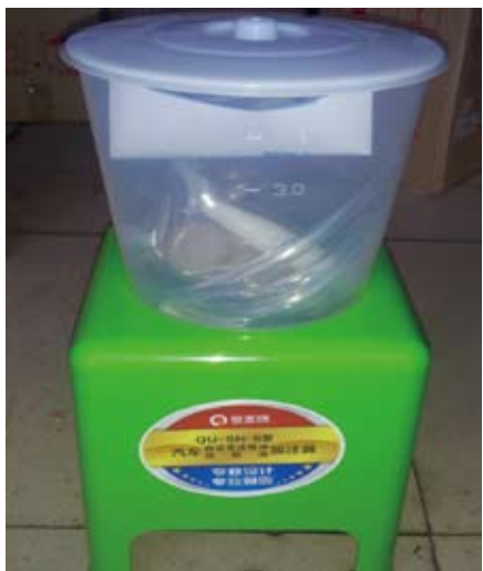
图32 传统手摇变速器润滑油加注设备
