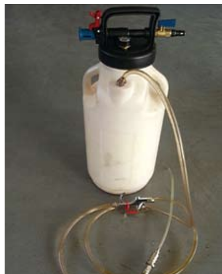
图30 气动变速器润滑油加注设备
