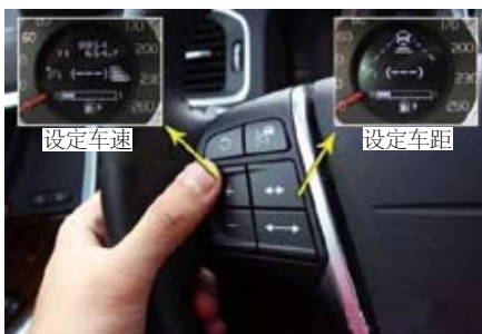
图1 通过转向盘上的按键设置巡航车速和车距
