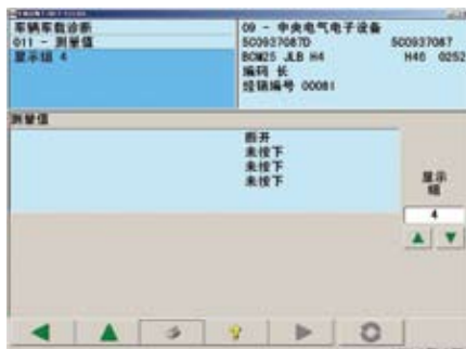
图2 09 中央电器控制单元数据流
