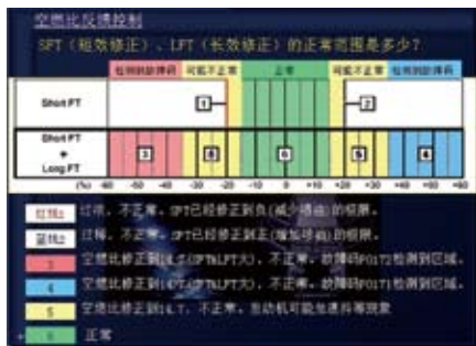
图3 发动机空燃比反馈控制图
