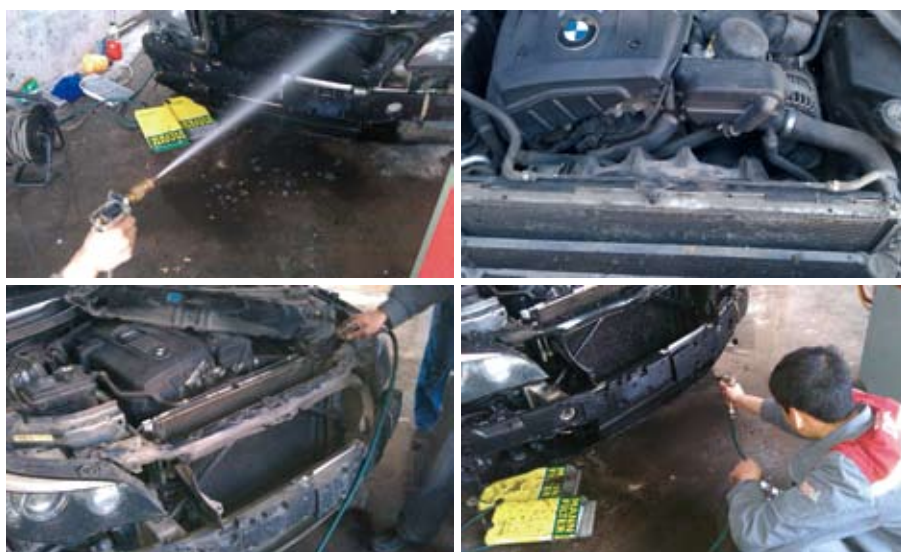
图4 冷凝器散热器脏堵检测、压缩空气除尘、高压水冲洗、压缩空气风干
