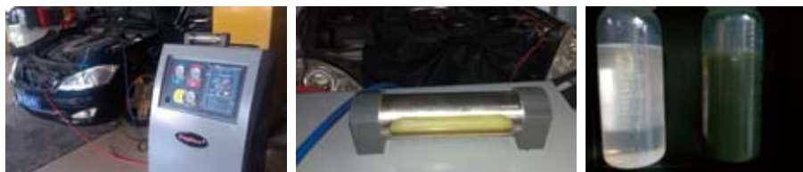
图3 专用设备、清洗过程、清洗后排油
