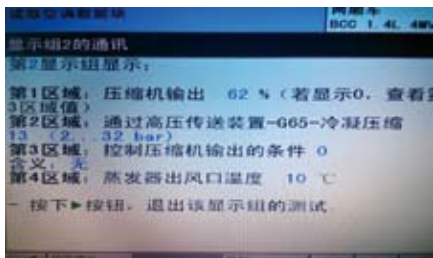
图4 更换传感器后读取数据流
