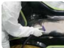
手刨打磨整平原子灰表面
