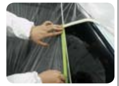
快速全面遮蔽不喷漆区域
