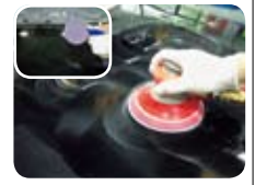
快速有效地打磨漆面缺陷
