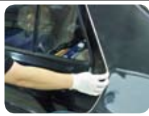
快速有效遮蔽车身缝隙
