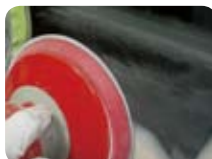
干磨机有效打磨修补面
