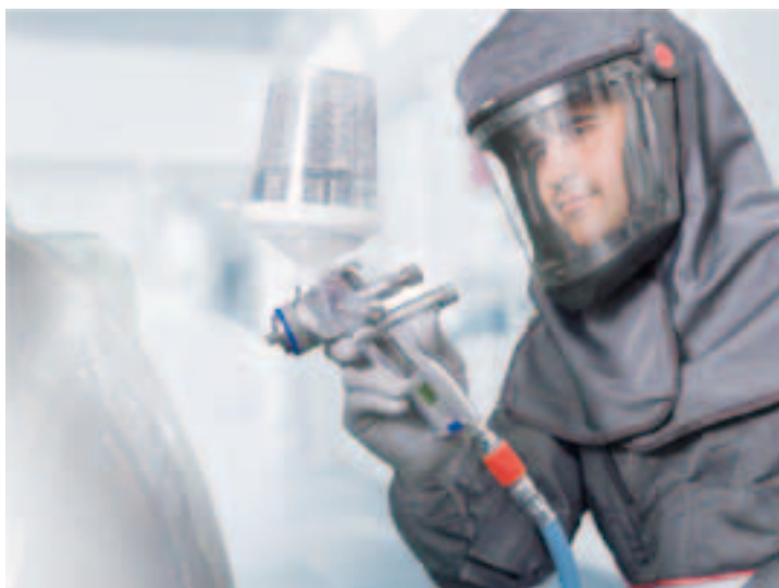
极度灵活的操作造到出色的喷涂效果:视乎涂料、环境和个人习惯,进气气压可以从0.05~0.24MPa之间调节,喷涂距离于10~21cm之间调节。
