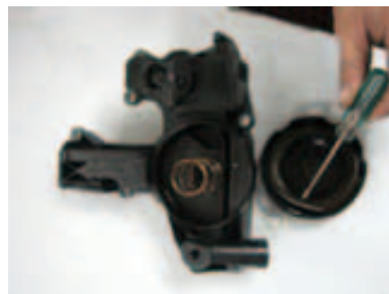
图3 故障车辆损坏变形的调节阀膜片
