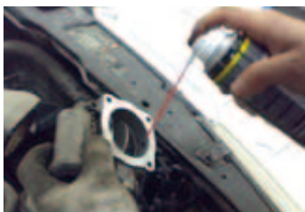
图1 洗清节气门机械部分
