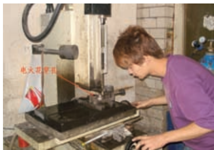
图2 利用电火花工艺穿孔
