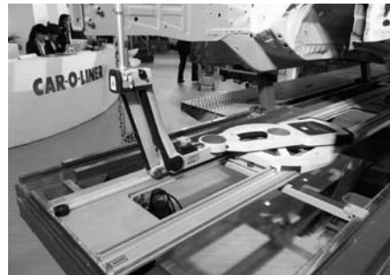
图1 采用节臂式测量方式的测量系统
