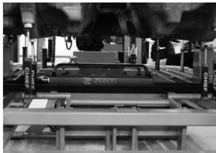
图2 采用激光测量方式的测量系统
