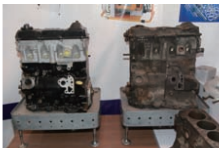
再制造前(右)后(左)发动机实物对比
