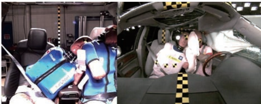
通用汽车业内首推前排中央气囊减轻侧撞对驾驶员与前排乘客的伤害(安装前后对比图)
